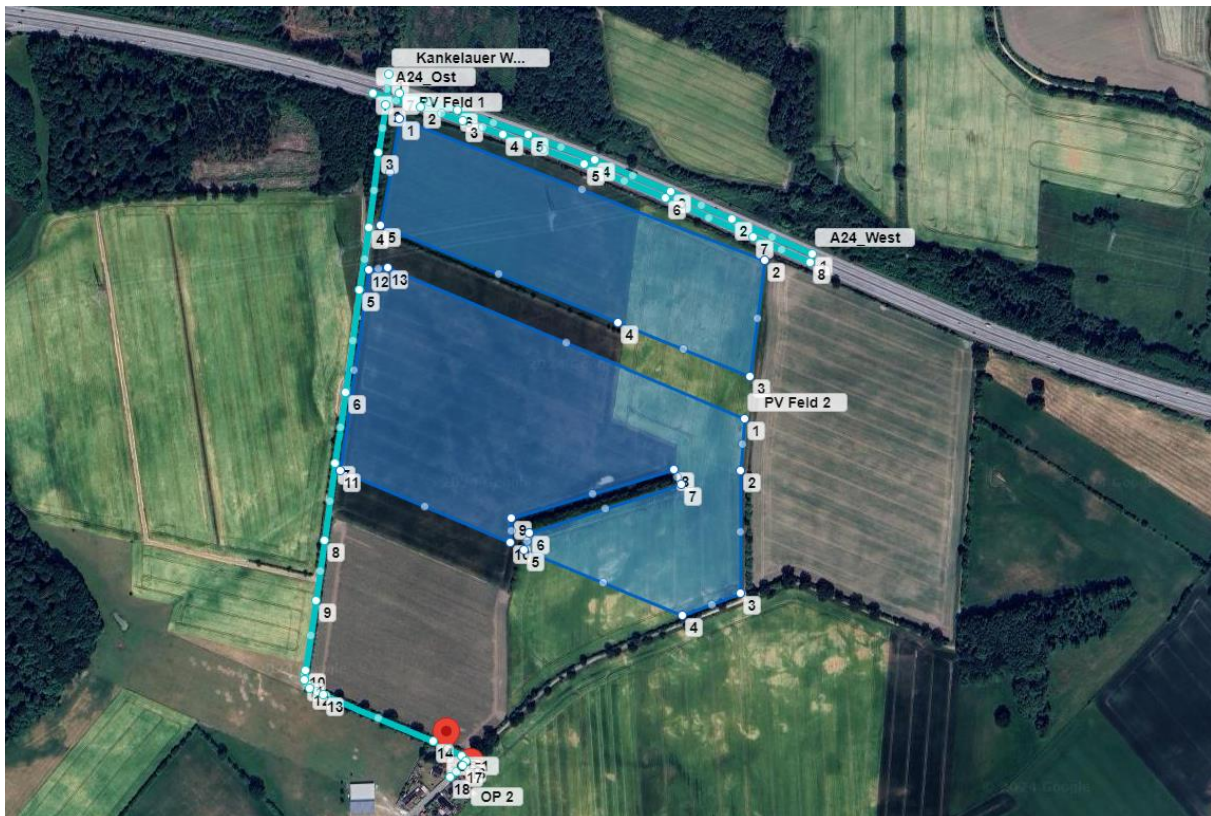
Abbildung 12: Anlage der PV-Flächen und Immissionsorte in der Simulationssoftware ForgeSolar
