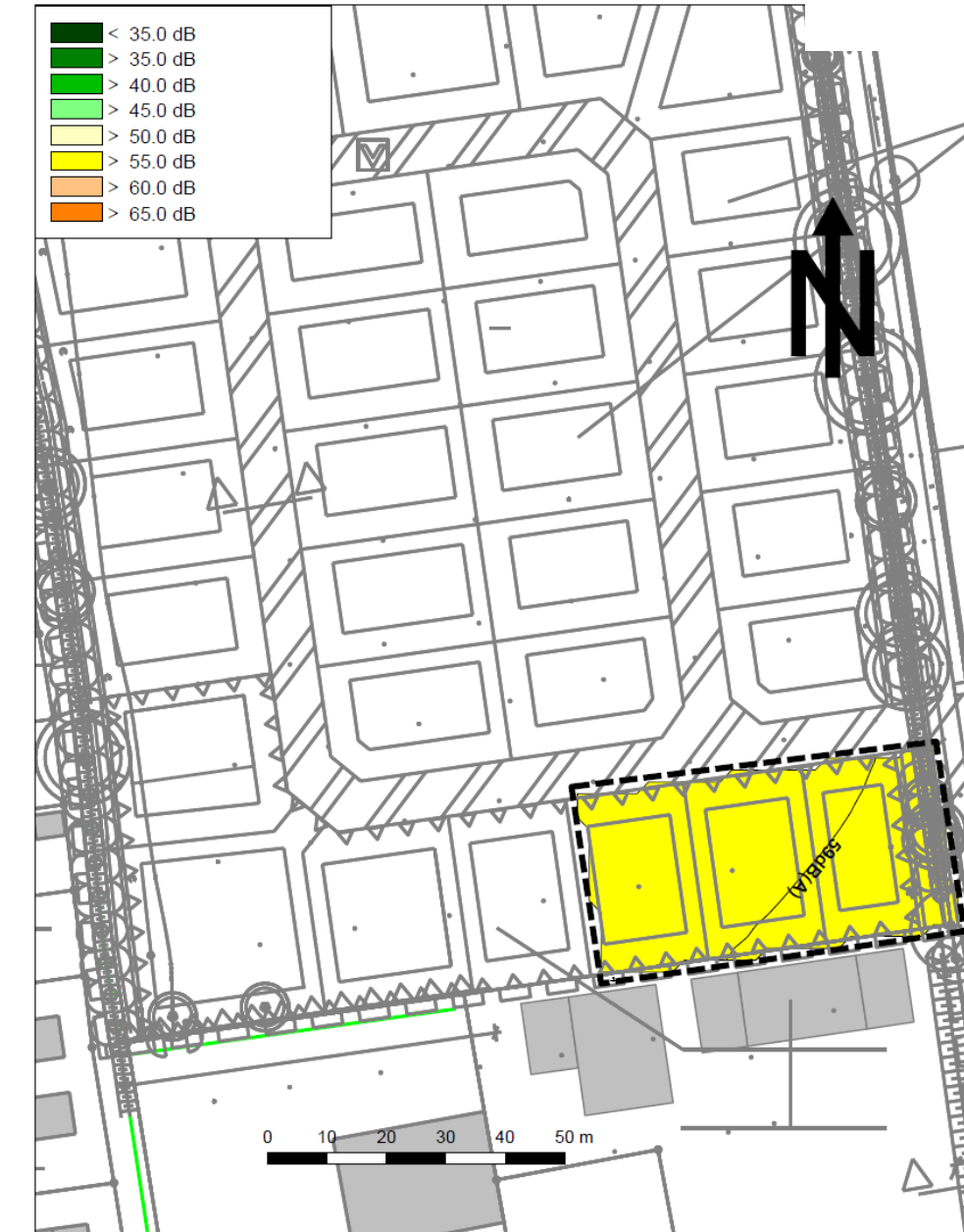
Abbildung 1: maßgeblicher Außenlärmpegel für schutzbedürftige Räume, Maßstab 1:1.000
